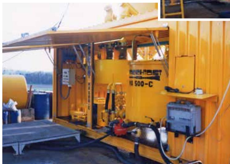
Fig. 10. Impianto di miscelazione MA 500 C e strumento di acquisizione dati PRS 3.
