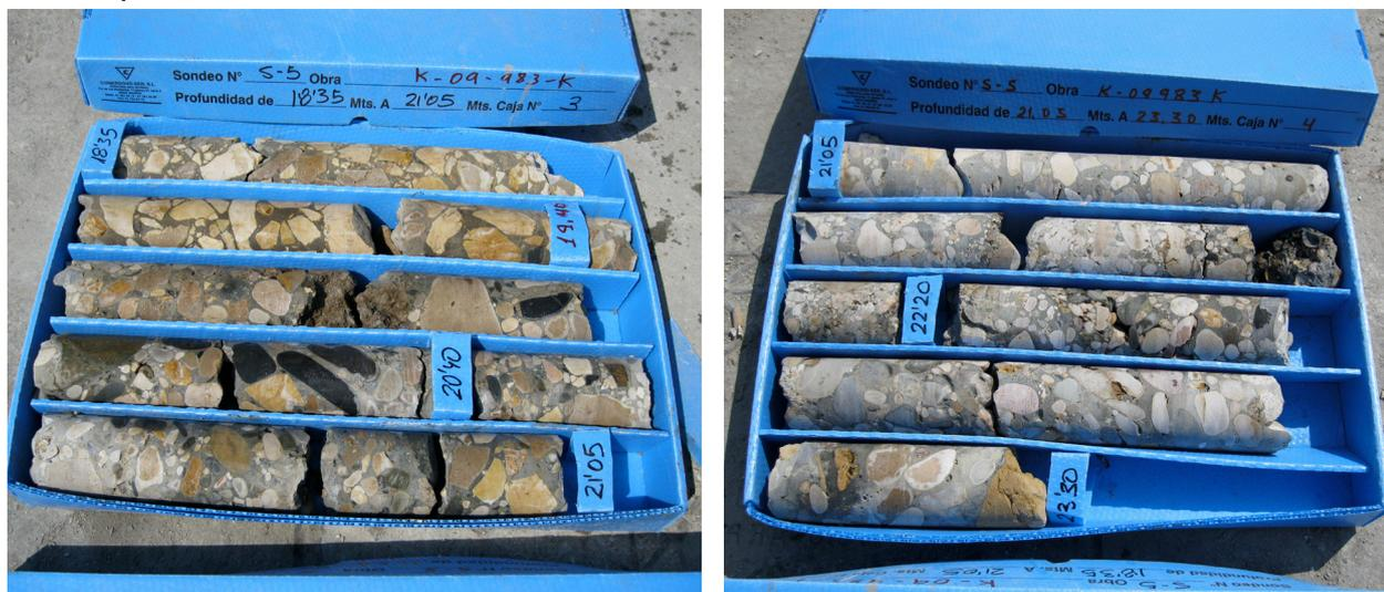
Fig. 7 e 8. Foto carotaggi eseguiti sulle colonne del lavoro sulle colonne del lavoro
