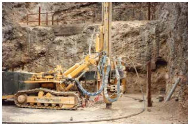
Fig. 11. Sonda PRP 105 durante la riperforazione del nucleo delle colonne.
